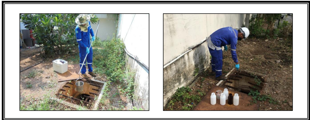
รูปที่ 3.1-7 จุดตรวจวัดคุณภาพน้ำทิ้ง บริเวณบ่อดักน้ำสุดท้ายก่อนระบายออกนอกโครงการ ประจำเดือนมกราคม - มิถุนายน พ.ศ. 2566
