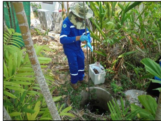
รูปที่ 3.1-3 จุดตรวจวัดคุณภาพน้ำทิ้ง บริเวณน้ำทิ้งก่อนบำบัด (Influent Tank) ระบบบำบัดน้ำเสีย อาคารสันทนาการ ประจำเดือนมกราคม - มิถุนายน พ.ศ. 2566
